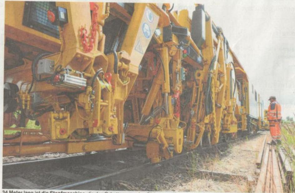
34 Meter lang ist die Stopfmaschine, die den Schotter unter den Gleisen und Schwellen verdichtet.
