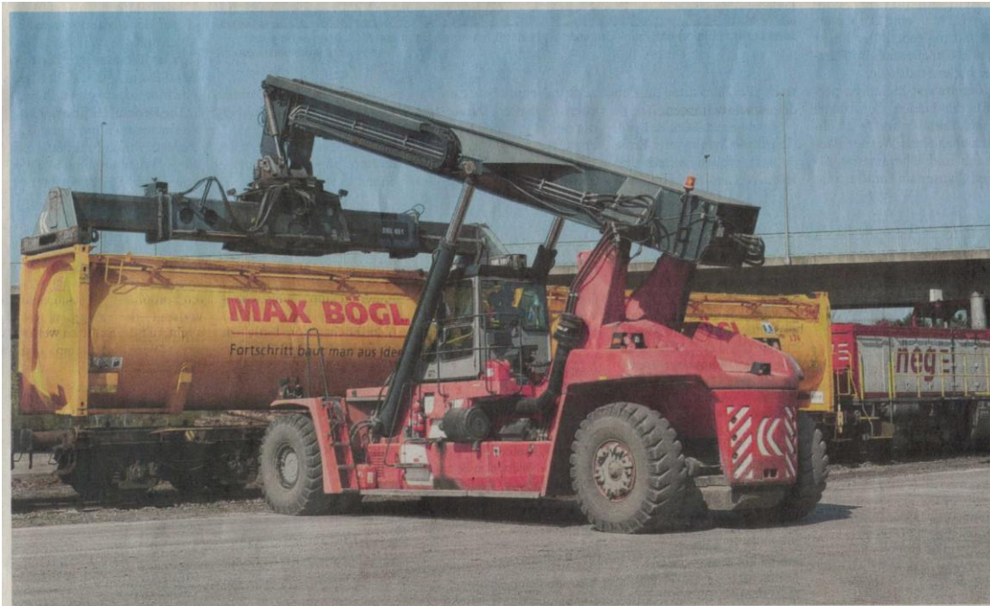
Die Reachstacker genannten Greifstapler verladen Container auf die Kombi-Waggons.
