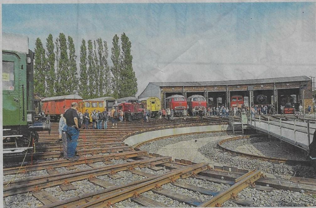
Die Besucher strömten zur Drehscheibe. Auf sie werden die Loks hinaufgefahren, gedreht und auf einem anderen Gleis wieder abgesetzt.
